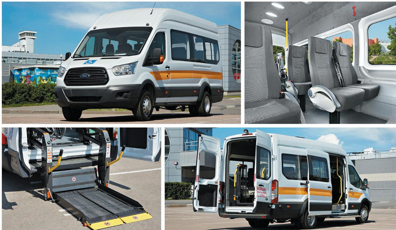
Специализированный автобус для перевозки людей с инвалидностью с подъемником
