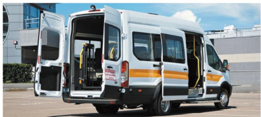
Специализированный автобус для перевозки людей с инвалидностью с подъемником
